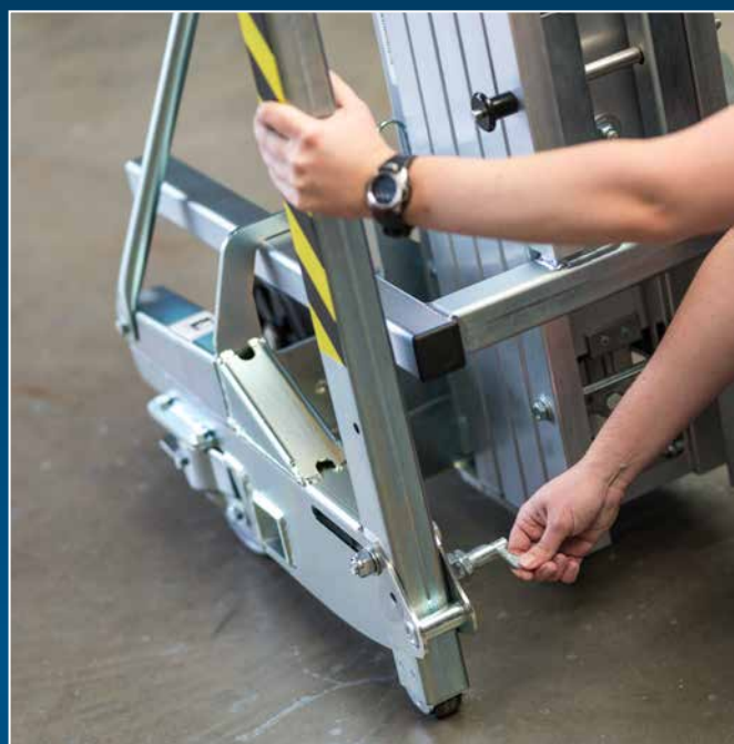
Despliegue y fijación de patas delanteras mediante pernos de resorte
