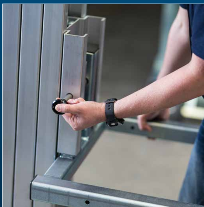
Montaje y ajuste de la horquilla mediante perno de bloqueo de bola
